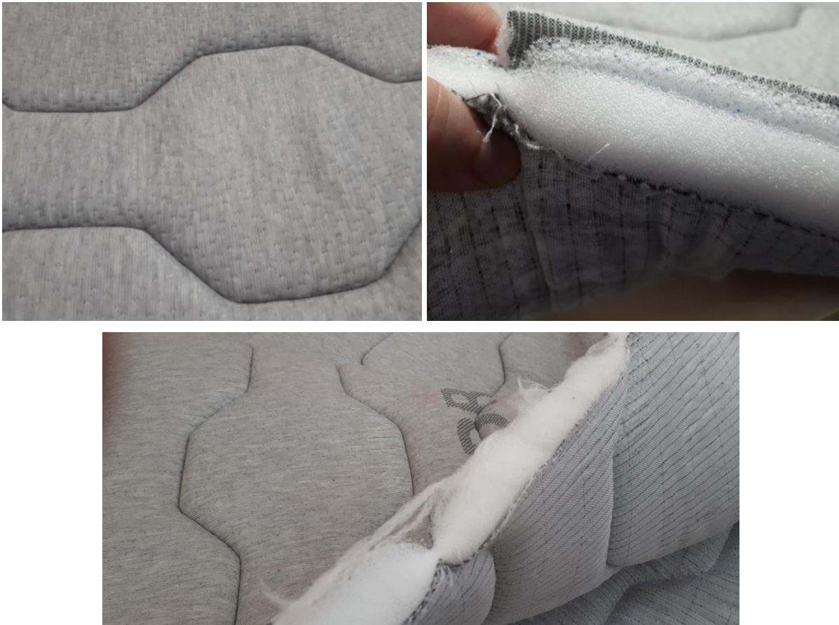
Aspecto del TEJIDO ELECTROSTATIC BALANCE NORMAL y los materiales textiles que lo componen.
